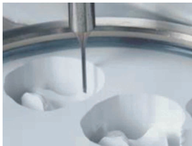
图19: 使用爱尔创UPMILL4022氧化锆加工设备进行牙冠加工。
